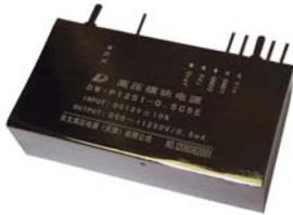
5E 系列是一款引针式高精度、超小型光电倍增管高压模块电源，正或负极性输出，通过外接电位器或外控电压，连续对输出高压进行线性调节。最低小于十万分之一的超低输出纹波，超强的过载保护，温度系数小于 50PPM/°C (典型值)，稳定度高，适用于 PCB 安装。
